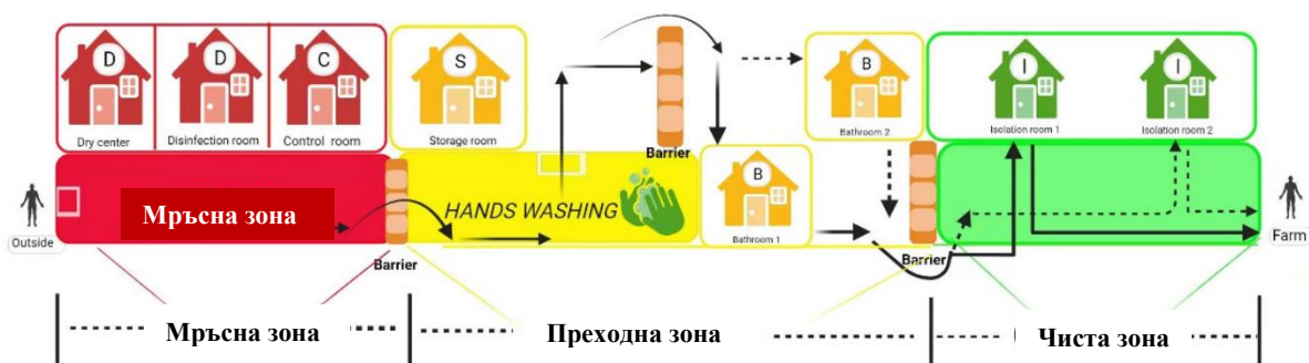
Фигура 3. Структурната схема на входния коридор за персонала и изолационните помещения. Стрелките означават еднопосочния пешеходен маршрут. Служителите оставят „мръсните“ си дрехи, обувки и шапки в мръсната зона, измиват ръцете си и се къпят
