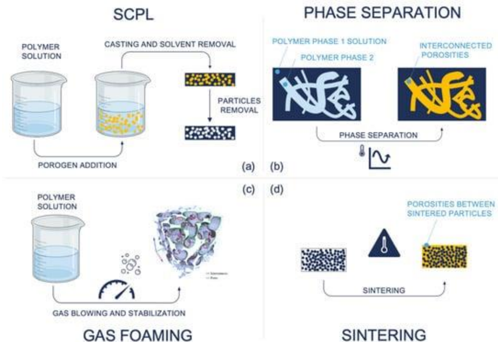
Фигура 2. Представяне на процеса на конвенционални технологии за производство на поресто скеле и пример за скеле, съответно (a) SCPL, (b) фазово разделяне, (c) разпенване с газ, (d) синтероване.
