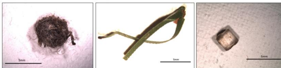
Фигура 6 От ляво: полиестер, поливинилхлорид и стиролова акрилонитрилова смола
